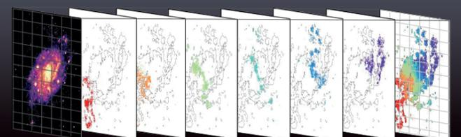
El instrumento crea un espectro en cada pixel de su cámara, mostrando la distribución de elementos químicos en diferentes partes de una galaxia. Esta técnica se conoce como **espectroscopía integral de campo.**
